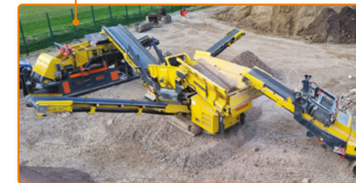
Gruppo Tornado nella configurazione scarrabile HLS. / Tornado group in the hooklift configuration HLS.
