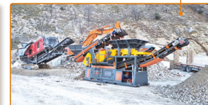
Tornado installato in un impianto fisso esistente per trattamento inerti da C&D. Tornado in plant for construction and demolition waste.
