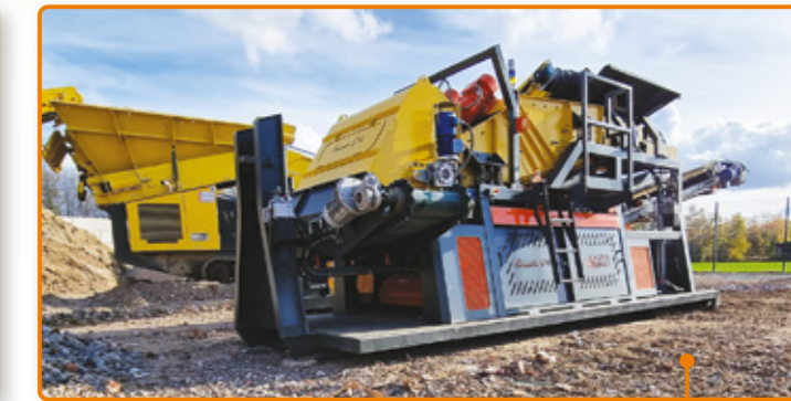
Gruppo Tornado nella configurazione scarrabile HLS. / Tornado group in the hooklift configuration HLS.
