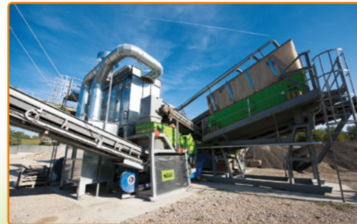
Accoppiamento macchine Tornado per trattamento diverse granulometrie di inerti (impianto frantumazione inerti C&D).
