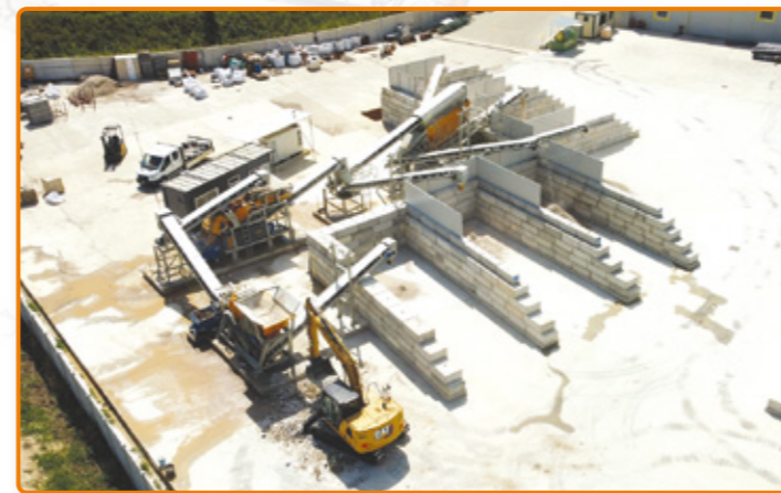
Accoppiamento macchine Tornado per trattamento diverse granulometrie di inerti (impianto frantumazione inerti C&D).
