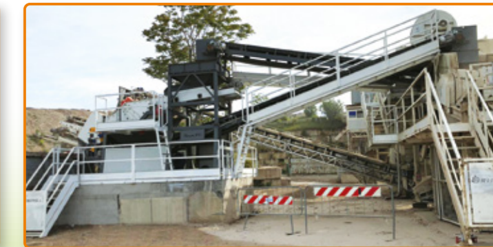
Tornado installato in un impianto fisso esistente per trattamento inerti da C&D. Tornado in plant for construction and demolition waste.
